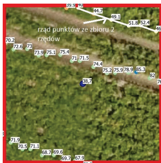
Rys. 7. Zróżnicowanie plonu w obrębie jednego piksela z satelity Sentinel-2, z zaznaczonym (biała linia i strzałka), rzędem danych plonu o niższych wartościach, zarejestrowanych podczas zbioru dwóch redlin, oraz plonem 38,7 t·ha -1 ocenionym ręcznie, na tle zdjęcia z drona
